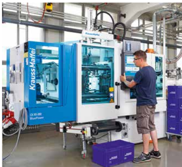
Bild 2. Mit der Wochenzeitschaltuhr „Weekly Timer“ lässt sich der Produktionsstart beim Spritzgießen exakt einstellen. Dadurch werden unnötige Maschinenwartzeiten vermieden
