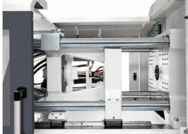
Bild 2. Die breite Abstützung der beweglichen Werkzeugaufspannplatte auf Linearführungen gewährleistet exakte Plattenparallelität (© KraussMaffei)
