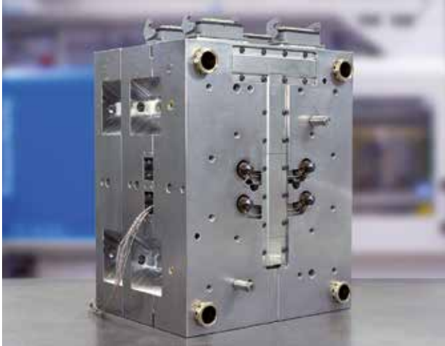
Bild 1. Heißkanal des Versuchswerkzeugs mit drei Platten, um die Länge der Schmelzkanäle in einem 96-fach-Werkzeug zu simulieren
