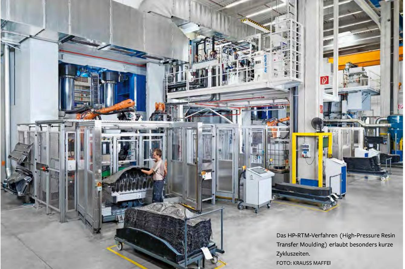
Das HP-RTM-Verfahren (High-Pressure Resin Transfer Moulding) erlaubt besonders kurze Zykluszeiten.
