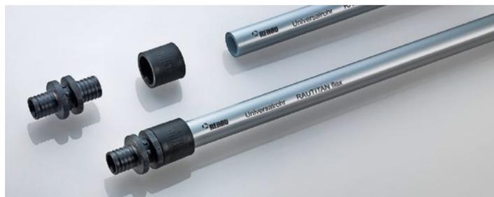
**Für mindestens 50 Jahre absolut dicht: Eine Schiebehülse aus PVDF presst die Rohrleitung auf das Anschlussstück (PPSU).**
