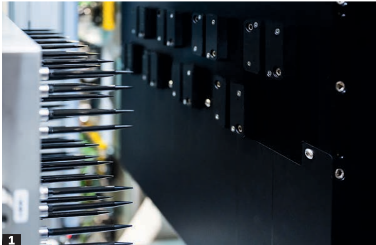
1 Spitzenkontrolle an den Pipettenspitzen (Side-view-Prüfung)
