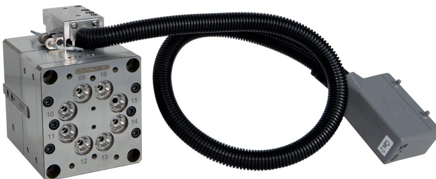
**Bild 3.** Wechselbarer Formeinsteckcluster für acht Pipettenspitzen mit eigener elektrischer Versorgung der einzeln beheizten Düsenspitzen © Männer
