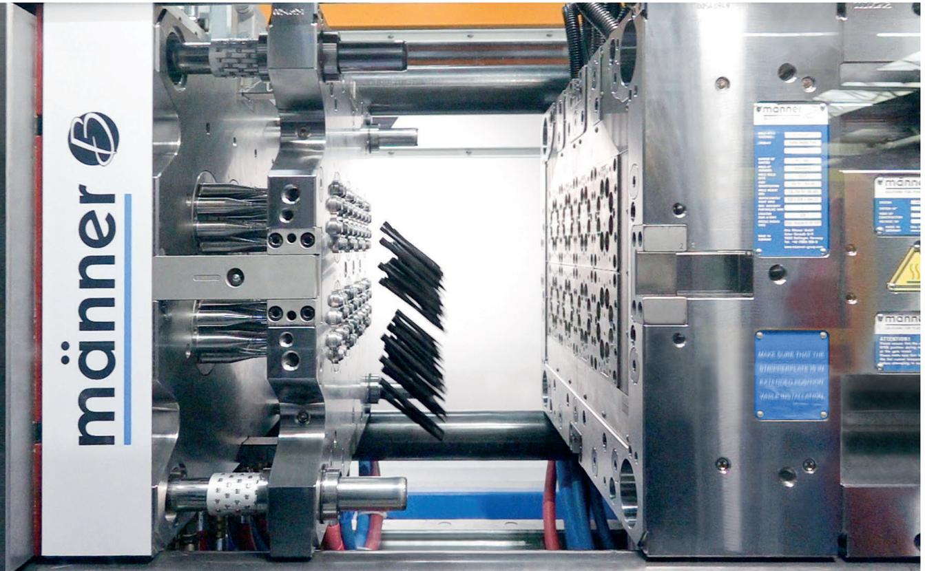
Im Männer Test-Center in Bahlingen: Spritzgießwerkzeug für die Herstellung von Pipettenspitzen im laufenden Betrieb. Die Automatisierung der Anlage ist derzeit noch im Aufbau © Männer
