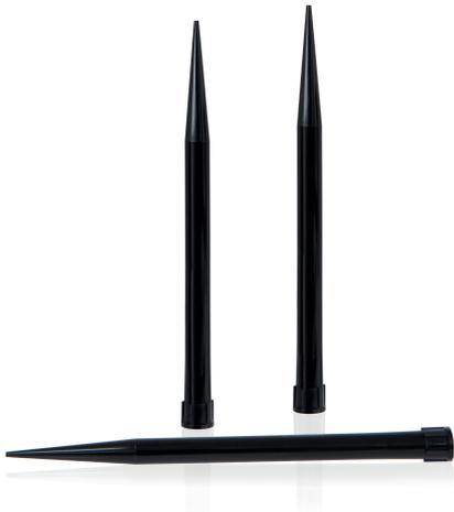
**Bild 4.** Pipettenspitzen für vollautomatische Pipettieranlagen bestehen aus leitfähigem PP, damit der Füllstand erkannt wird © Männer
