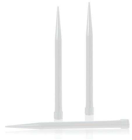
**Bild 1.** Pipettenspitzen aus PP. Die Wanddicke beträgt 0,3 mm, der Durchmesser der Ansaugöffnung 0,35 mm © Männer
